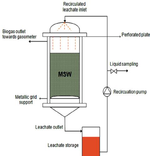
Fig. 2. Lysimeter scheme
